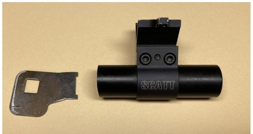
※工具の幅は15.5mmで内ネジの切欠きにピッタリ合うように製作。SCATT本体の素材がアルミニウムなのでネジ山を潰さないように慎重に作業する。
