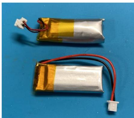
取り出したバッテリー（写真上）は劣化が進んで大きく膨張しているので、新しいものに交換する。
